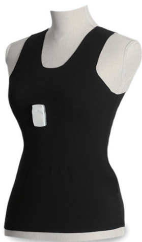
Fig. 4 シャツ型電極の例 (ミツフジ(株)による“hamon”)
