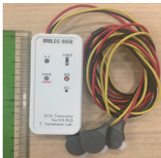
Fig. 2 共同研究者の山川らが開発した小型ウェアラブル心拍計
